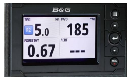
Smarttune sendet Vorstag-Last Informationen an die Bord-Instrumente.
