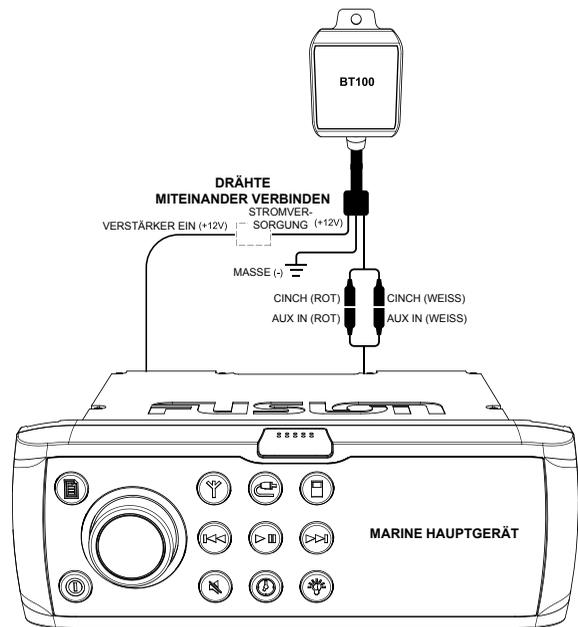
FUSION empfiehlt die Montage des MS-BT100 auf einer erhöhten Position und so weit wie möglich von Metallteilen entfernt. Damit wird die maximale Reichweite für das Bluetooth-Audio-Streaming sichergestellt. Etwaige Hindernisse zwischen dem MS-BT100 und Ihrem Streaming-Gerät reduzieren diese Reichweite.
