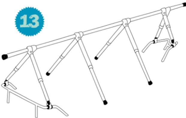
Das Gestell wird an Bug- und Heckkorb festgeschraubt (25 mm Rohrdurchmesser), die mittleren Stützen werden ans Süll gestellt.
